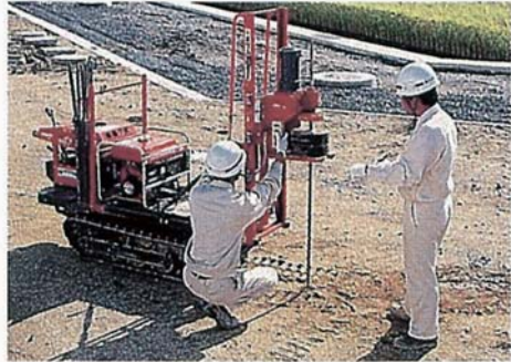
サウンディング試験で得た地中の情報をコンピューターで解析し、建築基礎構造設計指針にもとづいて検討します。
